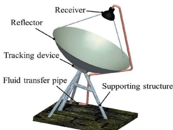
شکل ۵: اجزای کلکتور بشقابی سهموی
